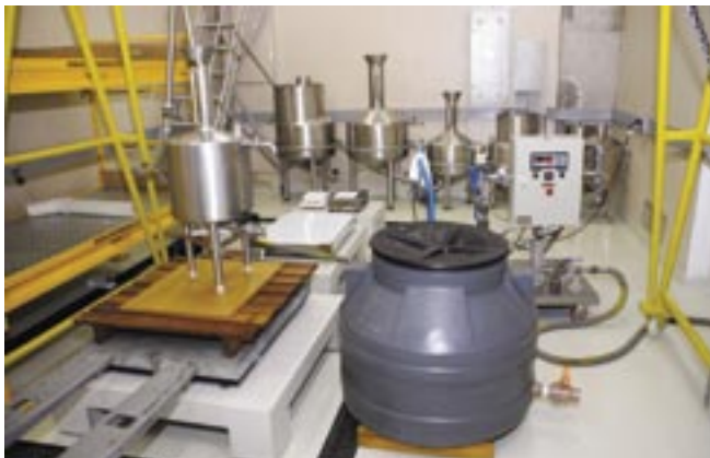
Tanques volumétricos padrão no Laboratório de Vazão
